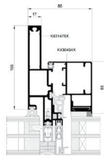
dwarsdoorsnede van de stijl met de raam MB-SR50N IW – EFEKT-versie
